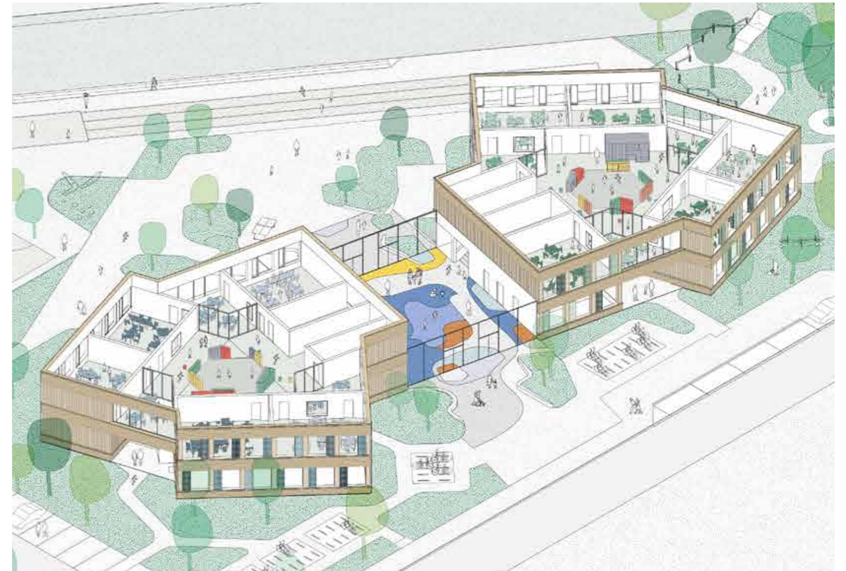
Konzeption einer Clusterschule in hybrider Modul-/Elementbauweise, entworfen von Sauerbruch Hutton, Berlin.
